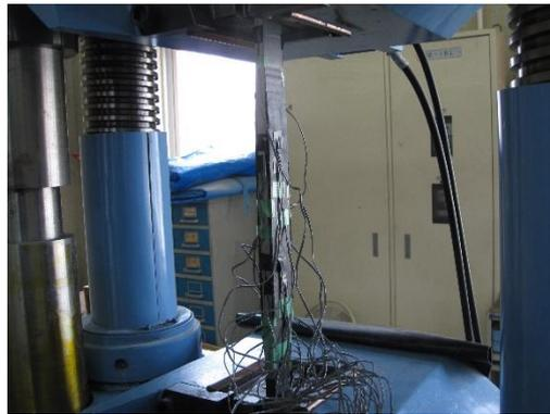
図3-3 事前塗布を行っていない試験体の二面引張剪断試験
