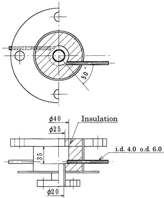
Fig. 2 Cyclone-jet combustor
