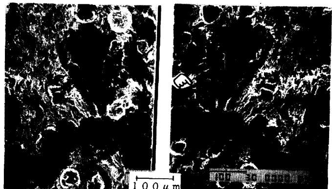
図 14 M-B 材のマッチング破面の SEM 写真
