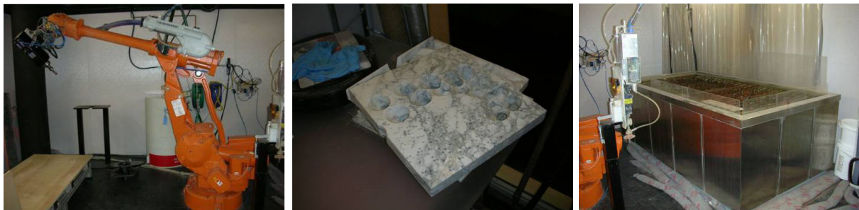
ロボティクスラボ ロボットアームにCNC加工機とウォータージェットを装着して金属や石をカット
