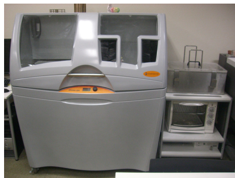
図 5.25 3D プリンタ（石膏パウダー積層型）
