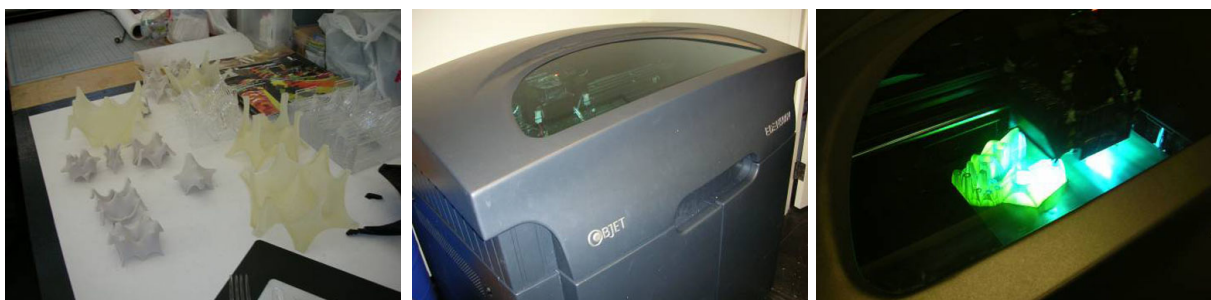
光硬化型3次元プリンタ 全米でもハーバードだけの機械とのこと
