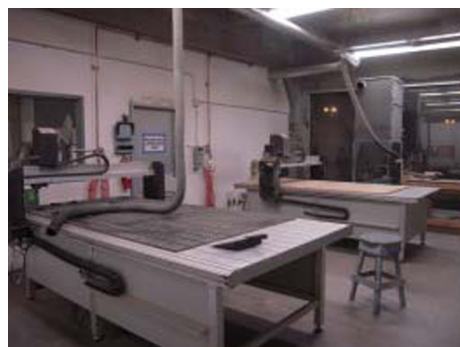
大型 NC ルーターが 2 台装備されている
