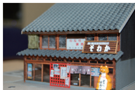
レーザーカッター導入により手作業では困難なサッシや格子などの忠実にカットすることができるようになり、素材感のある実物に近い模型を作ることが可能になった。
