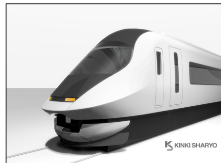
図 3.13 CAD による先頭形状確認
