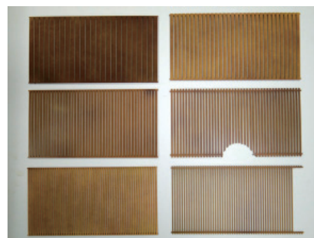
図 7.17 格子幅の検討模型（膳丸）
