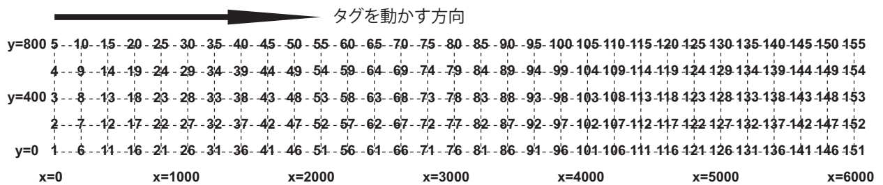
図 4.19 タグを設置する測位点 155 か所
