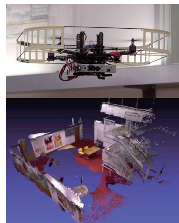
図5.6 Quadro Copterに搭載されたRGB-Dカメラでスキャンされた建物
