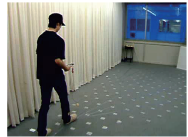
図4.4 床面に敷設された読み取り機とスリッパ型RFID
