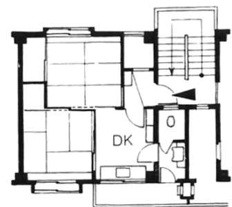
図 1.8 C51 型住宅の平面図
