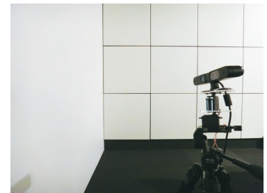
図 5.17 平面に対する誤差を計測している様子
