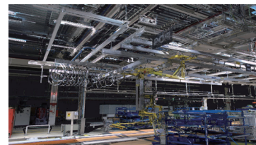
図 5.1 三次元スキャナを用いて建築形状を取得した例 出展：FARO
