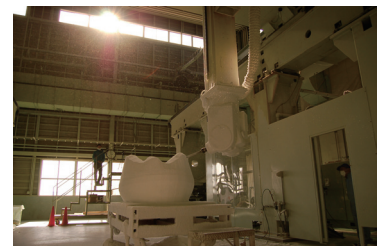
図 3.38 ヤマハ発動機大型4軸CNC機
