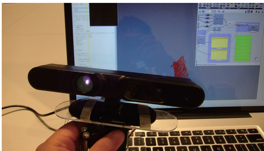
図 5.21 回転するサーボモータに固定された Xtion
