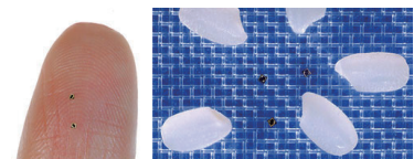
図 4.3 HITACHI が開発した極小 RFID
