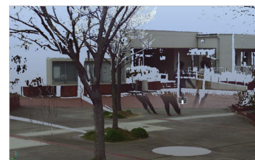
図5.5 動的な物体が存在した場合とスキャンによって生じる死角
