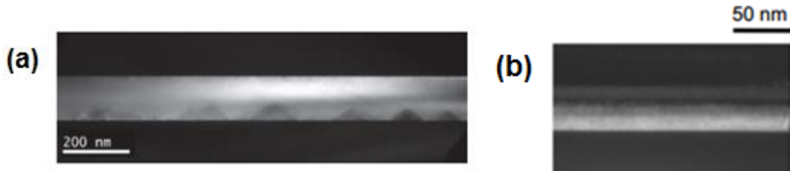
図 1.6 Si 基板上 GaP 層の断面透過型電子顕微鏡像. (a)MOVPE による Si(001)just 基板上への成長. 像下部のコントラストは、アンチフェーズドメイン(Anti phase domain)である. 文献[41]より引用. (b)MBE による [110] 方向に 4° 微傾斜した Si(001) 基板上への成長. 文献[43]より引用. 電子線回折条件は両図とも g=(002) ・暗視野.
