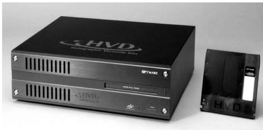
図 1.2.2-2 ホログラムメモリドライブのプロトタイプ．
