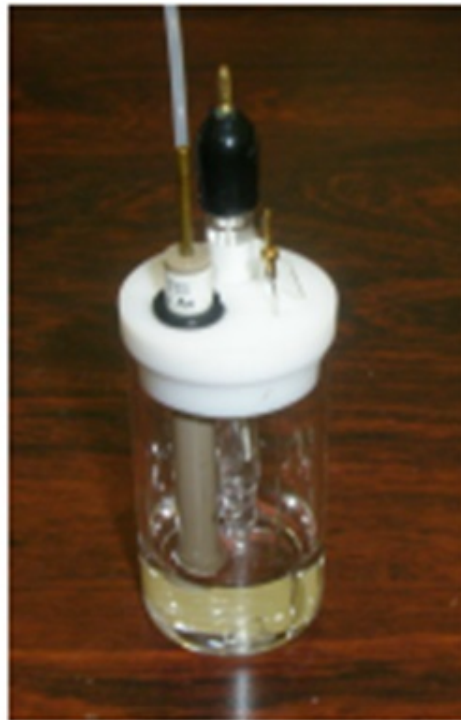
図 3.3: 電気化学セル (WE: Pt 電極 1.6mm \phi , CE: Pt 電極, RE:Ag/AgCl 電極)
