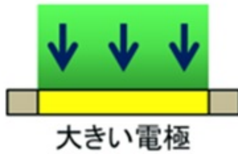
図 2.13: 拡散プロファイル (通常の電極サイズ)
