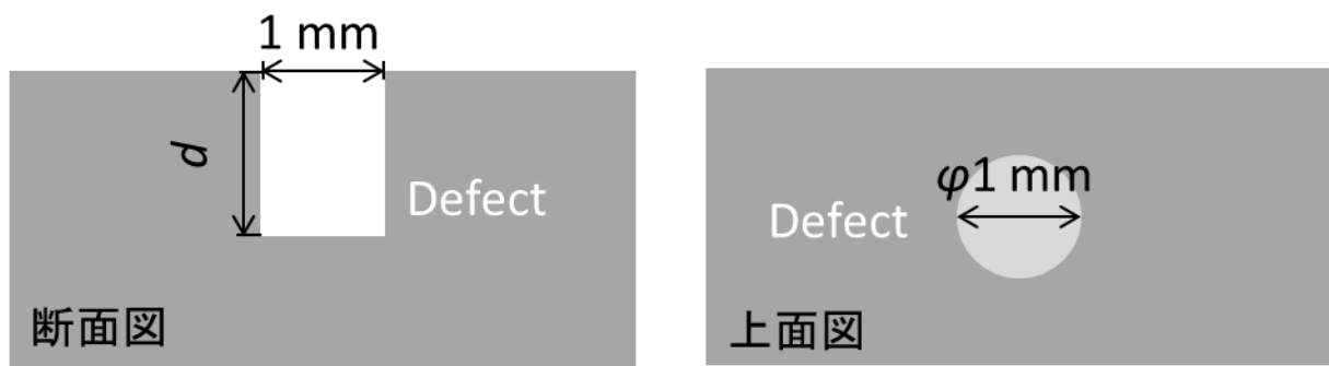
図 2.5.2-1 試験体および欠陥の模式図
