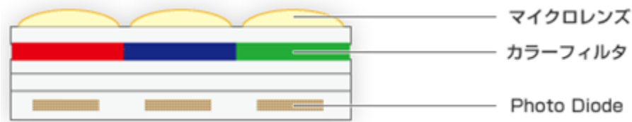
図 1.3 フォトダイオードと各カラーレジストを用いたカラーイメージングデバイスの概念断面図. 実際には, 光を集光するため各カラーフィルタ上にマイクロレンズを配置している. [9]
