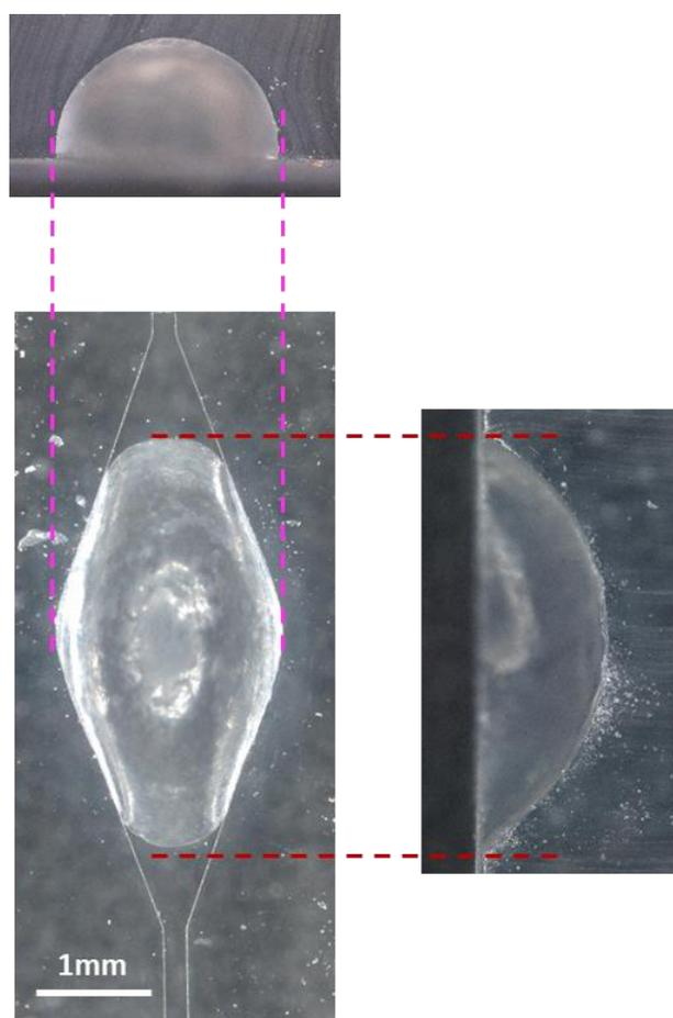
図 5.5 ワックスリフロー援用ソフトリソグラフィ法により作製した反応容器
