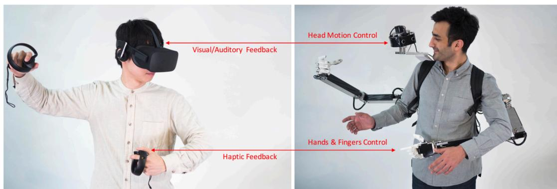
図 1.7 ウェアラブルロボットによる遠隔共同作業システム
