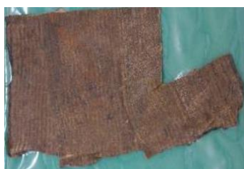
19年暴露試験体 (海水中, 海側)
