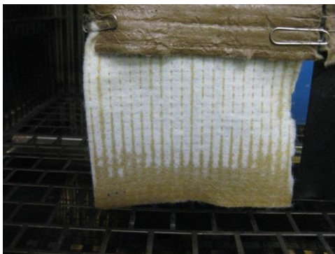
写真3.12 不織布の縫い目に沿った防食材の流動現象
