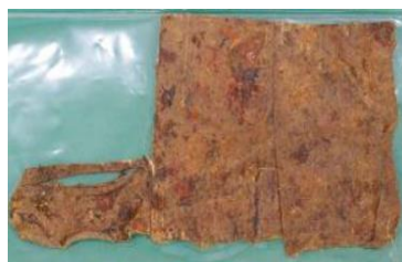
19年暴露試験体 (飛沫帯, 海側)
