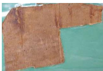
19年暴露試験体 (飛沫帯, 陸側)
