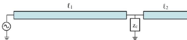
図 4.2 車両が走行する電化道路の高周波等価回路
