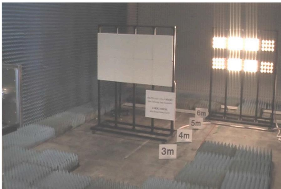
図 2.4 マイクロ波給電実験（手前パネル：受電レクテナ，奥に電球負荷） [43]
