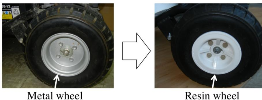
図 3.20 電動カート後輪ホイールの材質変更
