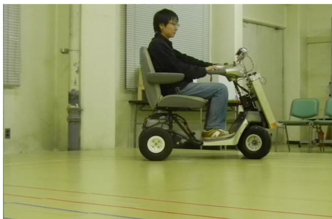
図 5.17 V-WPT による有人連続走行中給電実証
