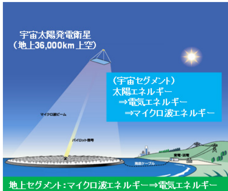
図 1.4 宇宙太陽光発電のコンセプト (出典：一般財団法人宇宙システム開発利用推進機構)
