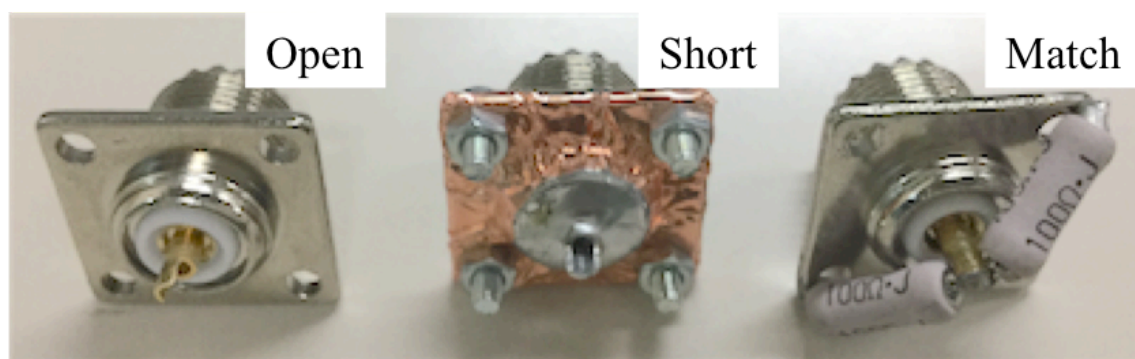
図 3.6 自作したキャリブレーションキット
