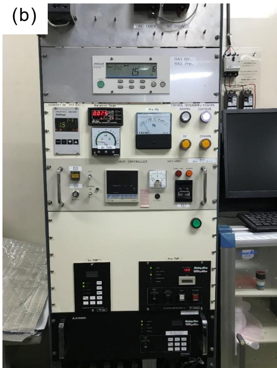
図 2.5 2 インチ VLS 結晶成長装置 : (a)成長装置の全体図、(b) 成長制御部(各種真空計、ポンプコントローラー、CGV 制御、温度制御)、(c) 基板ホルダー内カーボンヒーター
