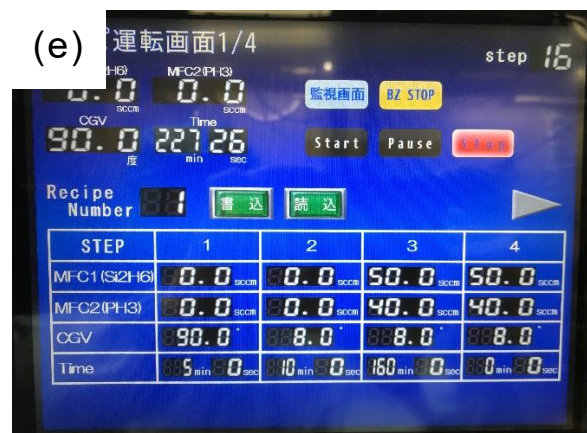
図 2.7 4 インチ VLS 結晶成長装置：(a)装置全体の外観図、(b)制御装置の外観図、(c) 空圧用電磁弁とマスフローコントローラー、(d)配管システムの制御画面、(e) 成長パラメーター管理画面
