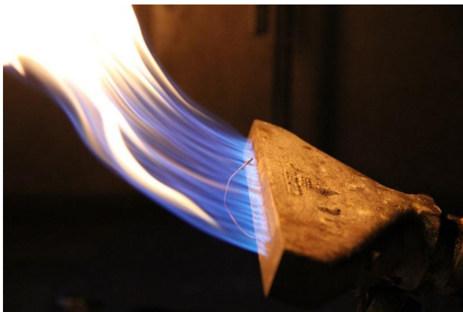
図 2-4 垂直トレイ試験用リボンバーナー ほぼ全ての試験方法で同型のバーナーが用いられている.
