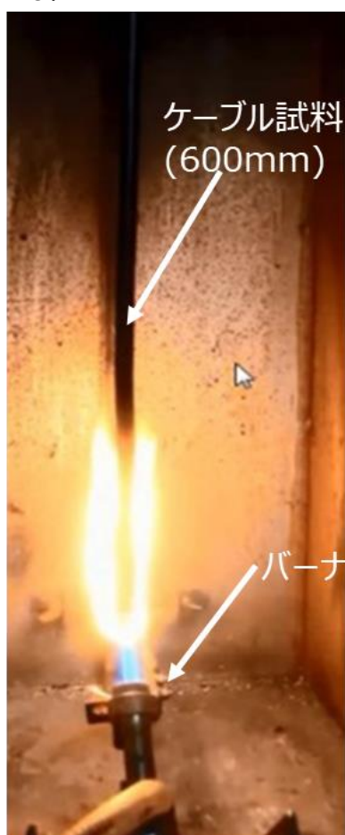
図 2-2 ケーブル一条の燃焼試験(IEC60332-1)
