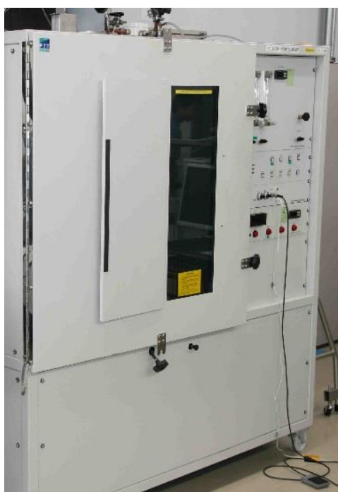
図 A1-1 NBS スモークチャンバ
