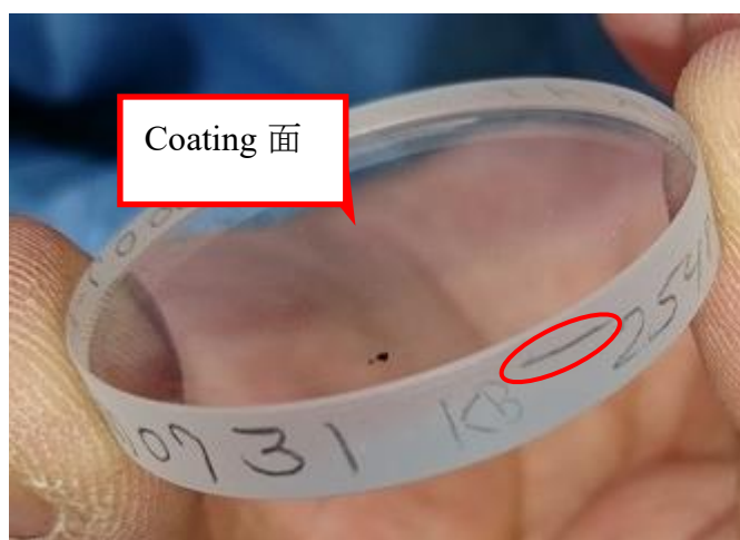
図 9 共振ミラー (Coating mark は赤丸中の線)
