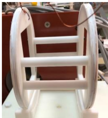
被覆込 外径0.9 mm (AWG20) → 連続使用 許容電流11 A
