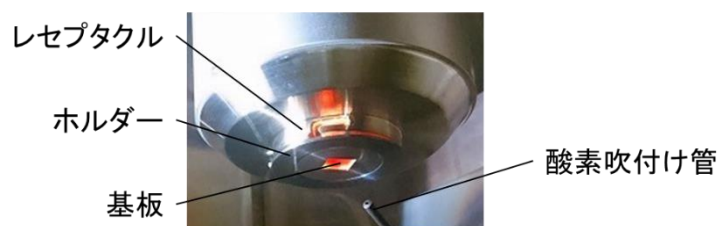
図2 基板ホルダーの取付け
