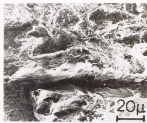
写真3-4 切欠き試験片の -196℃における 破断面
