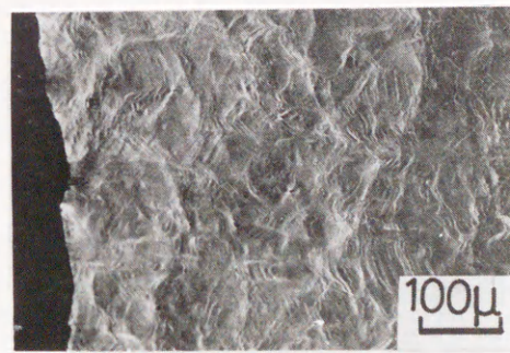
写真3-10 平滑試験片の破断部近傍における結晶粒の変形模様
