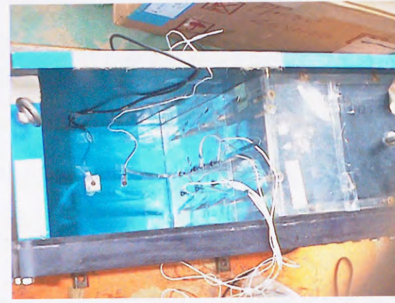
写真4-4 補強材と土圧計の取り付け
